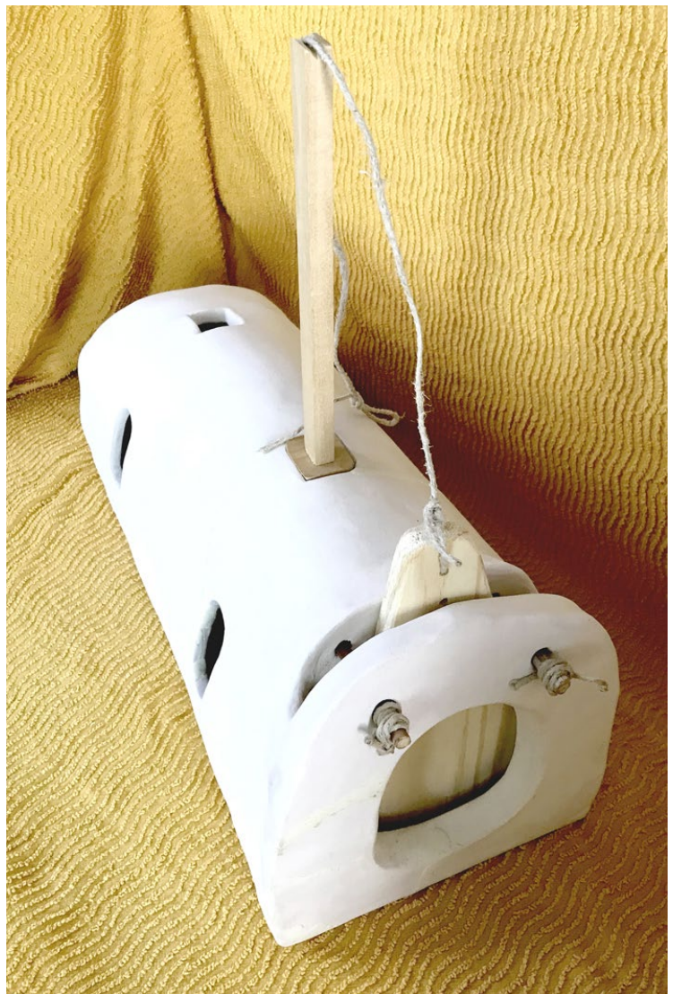
Fig. 3. Après traction de l'appât vers l'intérieur du piège, la ficelle est relâchée et la porte fermée. Photo: F. Laroche-Traunecker.
