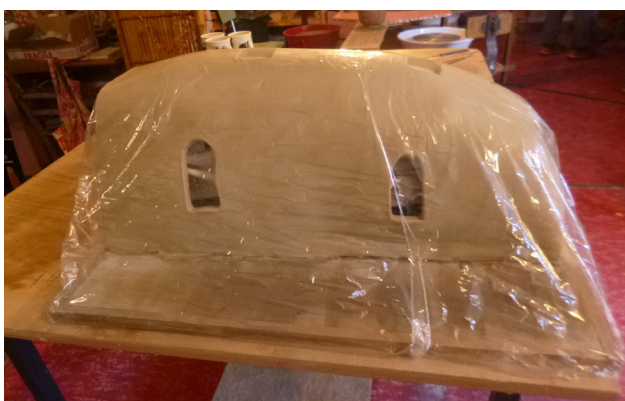
Figure 5 : le piège protégé par emballage d'une fine feuille en plastique pour un séchage progressif.
