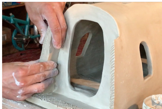
Figure 6 : détail de l'assemblage à croissillons et barbotine d'un côté de la glissière.
