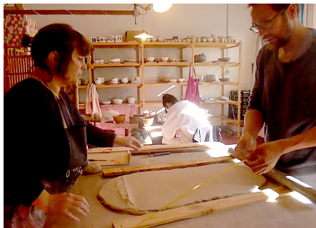
Figure 2 : travail de la pâte dans l'atelier de poterie ; préparation de la plaque de base n° 1, aplanie au rouleau à l'épaisseur voulue. Photo : F. Laroche-Traunecker.
