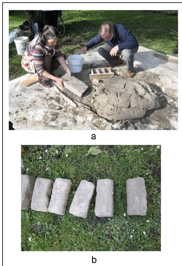
Fig. 6 : Démoulage des briques (a) et séchage des briques (b), photos I. Weygand.
